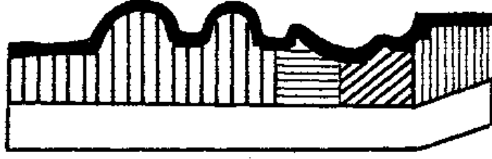
Şekil: 6 — Zemin üzerine yatırılan gömlek, içine yerleştirilen kalıplar ve alçı döküm uygulaması.
